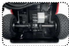
Uložení masivní zadní převodovky Weibang HEAVY-DUTY
