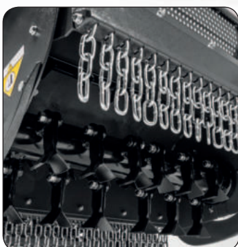
Čepele z vysokopevnostní oceli typu „Y“ ostré a velice odolné.
